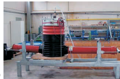
Test de presiune la caminul Wavin Tegra 600
