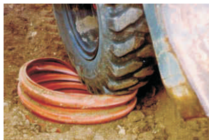
"Run over" - Test de rezistenta la incarcare
