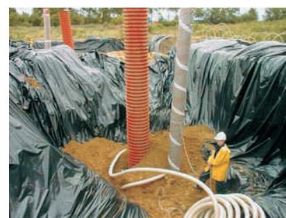
Test de flotabilitate pe termen lung la caminul Wavin Tegra 600
